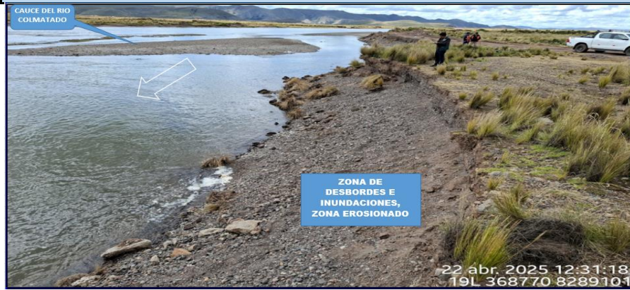
FIGURA 1 y 2: TRAMO CRÍTICO EN EL RÍO CHICO CABANILLAS, EN EL SECTOR CAMBRACA YOCARA, DISTRITO DE JULIACA, PROVINCIA DE SAN ROMÁN- PUNO. NOTESE, LA ACUMULACION DE MATERIAL SEDIMENTADO EN EL CAUCE, QUE REQUIERE SER ELIMINADO PARA REESTABLECER LA SECCIÓN HIDRAULICA DE LA CAJA DEL CAUCE EN ESTE SECTOR.
